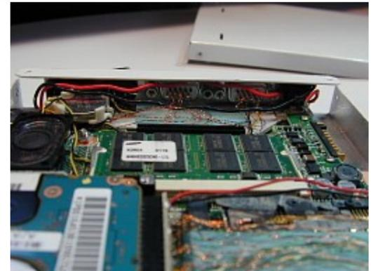
コネクタのブラケットはアルミ 1tから作ります。強度を出すためコの字に曲げてます。このあとコネクタに合わせ穴あけします。逆はだめですよ、うまく曲げができなくなりますので。マザーとの固定、アルミ1tのままでは強度不足なので、1.5tを接着して補強しました。
