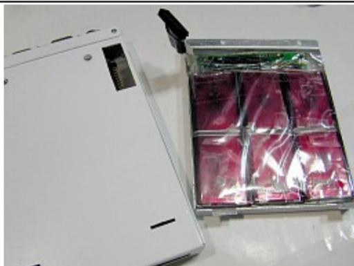
テストではOKだったのですが、いざ組み込んでみると動かない。しらべるとバッテリーセルの保護ヒューズがいくつか飛んでました...、バッテリー基盤もなんかおかしい... どうも絶縁フィルムがうすくてケースのアルミ(GND)とショートしてしまったよう。(T.T)
