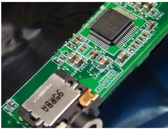
写真左: サウンドチップ Conexant CX20583-10Z
